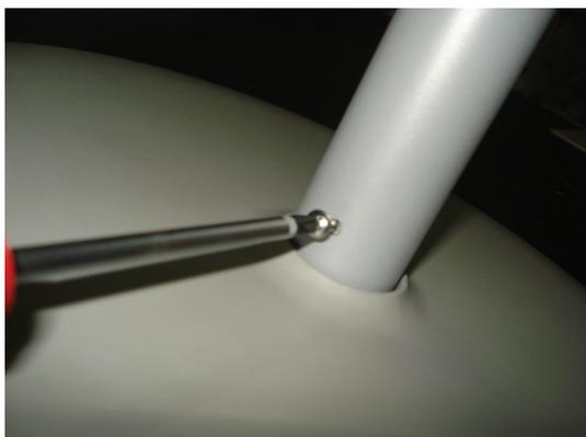
**3** Trovato l'allineamento, fissare con giravite la vite autofilettante, che si trova in dotazione nel sacchetto.
